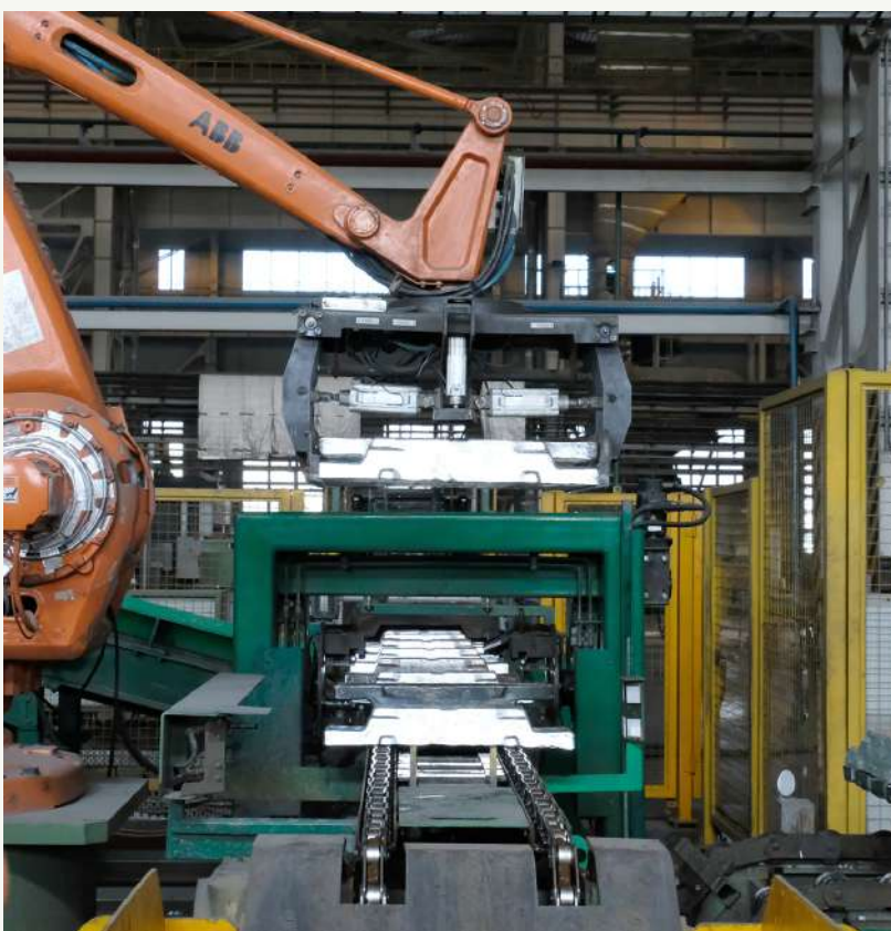
Робот, который без остановки укладывает чушки в штабеля.
